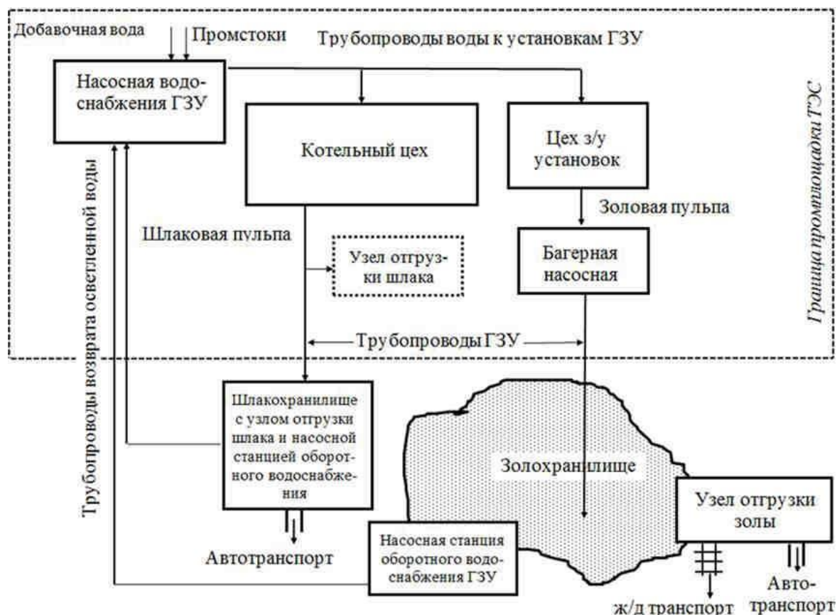
Рисунок 2.32 – Блок-схема системы ГЗУ с разделением удаления, складированием и отгрузкой золы и шлака
